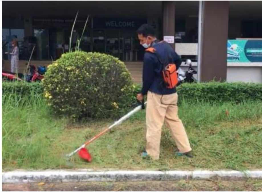
ภาพที่ 8 แสดงการใช้เครื่องตัดหญ้าไฟฟ้าทดแทนเครื่องตัดหญ้าเครื่องยนต์
