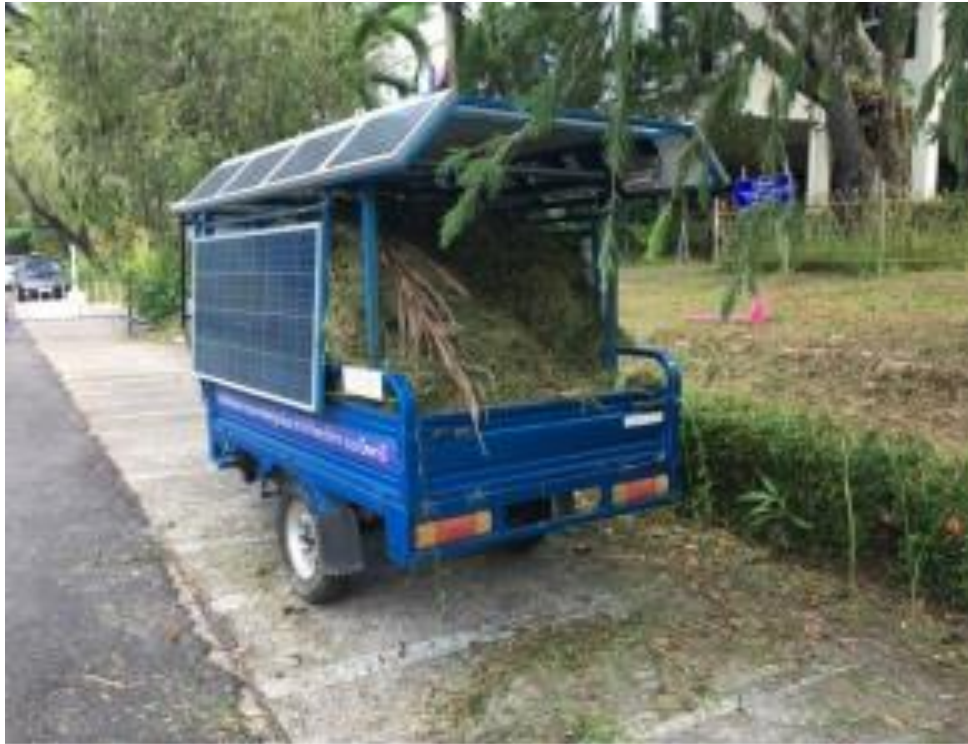
ภาพที่ 5 แสดงการใช้รถสามล้อไฟฟ้าโซลาร์เซลล์ในการขนเศษวัชพืชไปทำปุ๋ยหมักไม่กลับกอง
